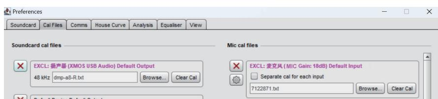
REW 启动之后，点击右上角的 Preferences 按钮，进入配置界面。默认看到是 Soundcard 界面，在这里需要设置声音的输出和输入设备，我们选择了 DMP-A8（图片中显示的是 DMP-A8 的驱动名字）和 MIC 并选择测量的通道，示例测量的是右声道。
