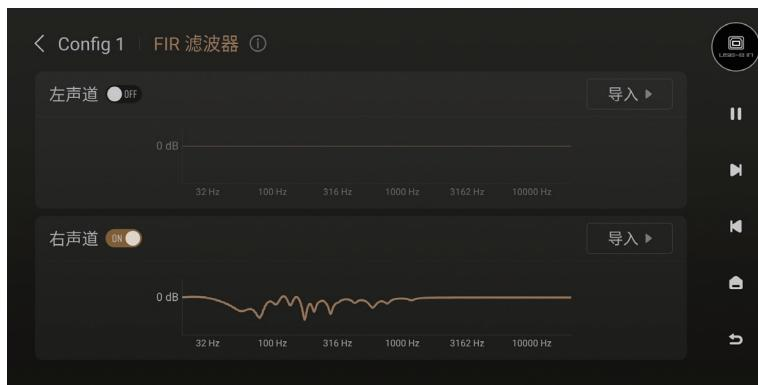
接下来，我们验证 FIR 滤波器是否生效。记得将 FIR 滤波器界面中右声道的开关打开，输入源 DSP 开关也要打开
