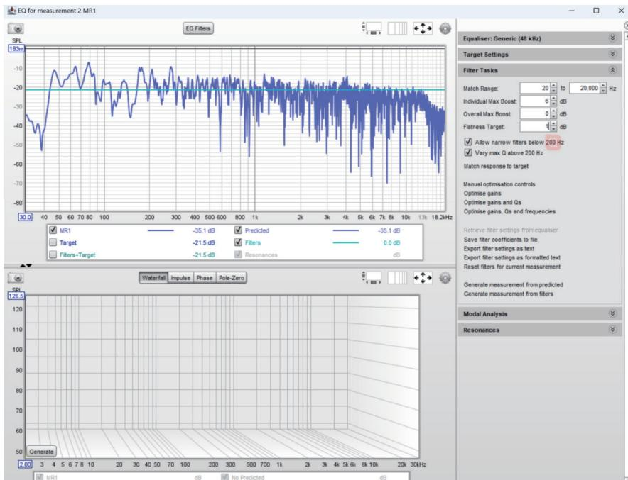
以上参数设置后之后，可以点击 Match Response to Target 启动 REW 的自动滤波器分配和调整过程，即生成校正 EQ 和响应。
