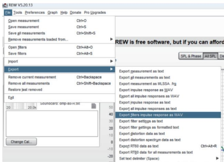
因为我们只测量右声道，所以选择单声道，保存的数据类型建议使用 32 位浮点数。最重要的一点是采样率必须设置为 48000 跟 DMP A8 DSP 的数据处理使用的采样率一致。点击确定保存成一个 wav 文件，我们命名为 MR1-filters，将文件拷贝到 U 盘上备用。
