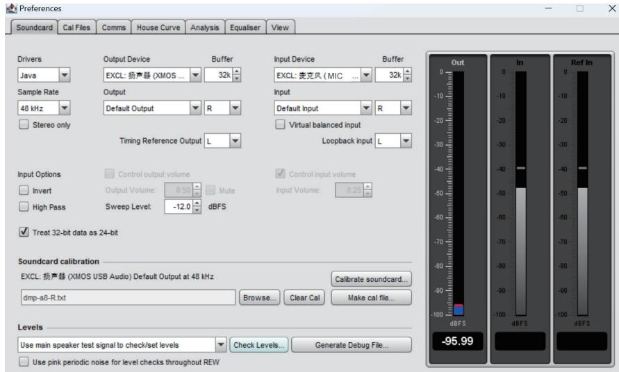
开始测量之前，点击 Check Levels 检查输入电平，确保其符合 REW 的要求，如果过低，可以增大 DMP-A8 音量。过高则减小 DMP-A8 的音量。如果没有校准过的声卡，可以点击 Calibrate soundcard，依照界面下方提示测量声卡。
