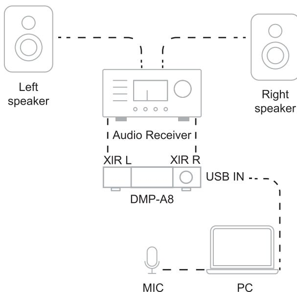
首先将 DMP-A8 设置为声卡，PC 通过 USB 线缆与 DMP-A8 连接。使用 REW 推荐的测量 MIC，同样通过 USB 线缆与 PC 连接。然后 DMP-A8 使用 XLR 连接到功放，功放驱动音箱发声。DMP-A8 和 MIC 不是必选的，你也可以自行选择信任的声卡和 MIC。我们建议使用经过校准的声卡和 MIC 作为测量设备。
