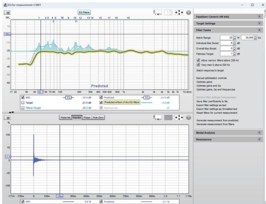
至此我们完成了对一次测量的校正。如果对校正结果不满意。可以调整做多组测量取平均值，调整目标电平和滤波器参数，直到达到预期的结果。
