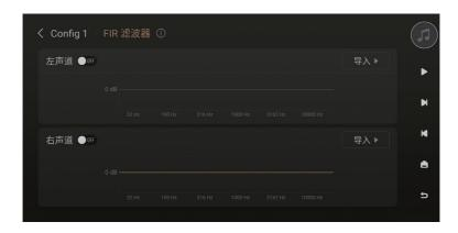
FIR Filter 只支持文件导入的方式。可以针对左右通道设计不同的值。
