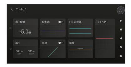
此图表示的 DSP 内部信号处理的流程,信号从 In 进入,通过每个模块处理后,最后从 Out 输出。
